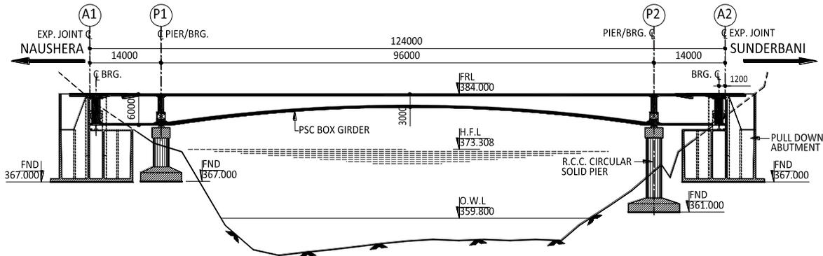
Fig. 2 : General Arrangement Drawing
